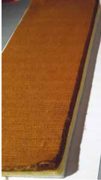
(a) Uzak gemisi yalıtım keçesi (PBI/para aramid/meta aramid)
